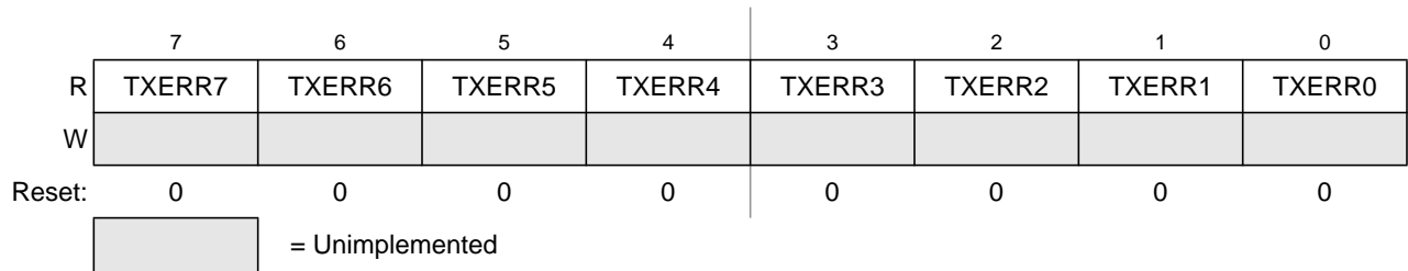
Figure 10-18. MSCAN Transmit Error Counter (CANTXERR)
