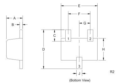
DIMENSIONS INCHES MILLIMETERS SYMBOL MIN MAX MIN MAX А 0.023 0.031 0.58 0.78 В 0.002 0.008 0.04 0.20 0.54 С 0.013 0.021 0.34 D 0.059 0.067 1.50 1.70 Е 0.059 0.067 1.50 1.70 1.10 F 0.035 0.043 0.90 G 0.020 0.50 Н 0.031 0.039 0.78 0.98 0.010 0.014 0.25 0.35 J
